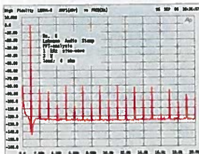
Ved 3 W i 4 ohm aflæses THD+N til 0,030%. Der er stadig de harmoniske af ulige orden, der dominerer, her med max. i form af 5. til 11. harmoniske.
