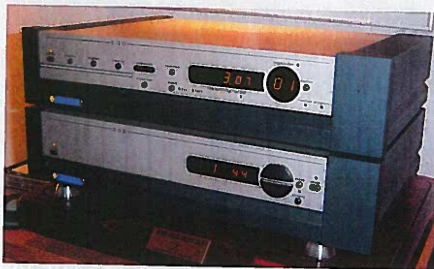
CD pladerne afspilles på denne to-delte Proceed med værk og processor. Hele moleviteten er godt afkoblet med både Audio Magic hylden og ekstra SD-fodder.
